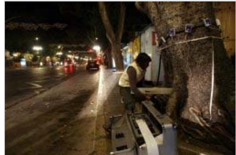
Madera sana: este sistema mide la resistencia del tronco a la perforación con una broca de escasos milímetros
